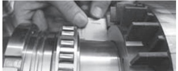
Bild 8.5: Gap measurement
