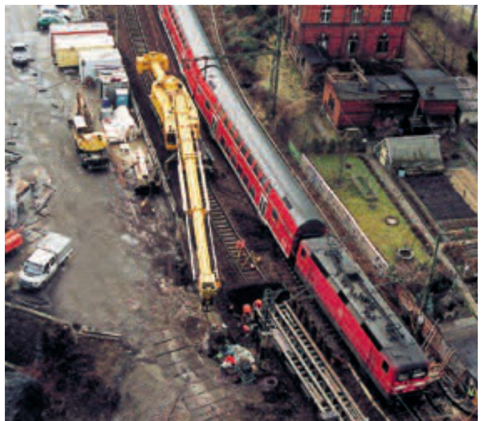
↑ Specjalne rozwiązanie przeciwwagi pozwala na bezproblemową pracę tylko z jednym podparciem
