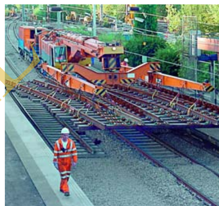
↑ Tylko Multi Tasker może przewozić tak szeroki ładunek po szynach
